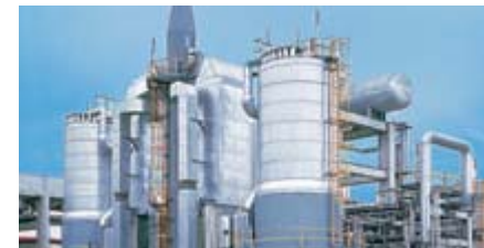
▲ Zur Verbrennung von flüssigen Rückständen dient diese Wärmeträgeranlage in den Niederlanden (Leistung total: 26 MW bei 330 °C).
